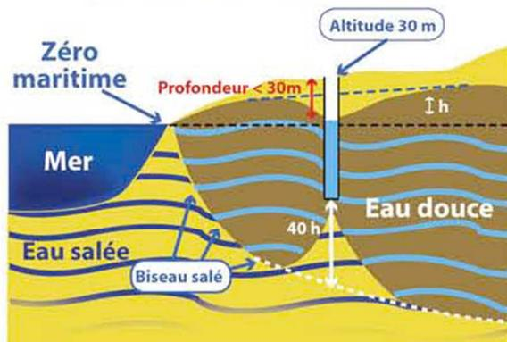
Pour un forage situé à 30 m d'altitude, la pompe devra être installée à moins de 30 m de profondeur par rapport au sol.
