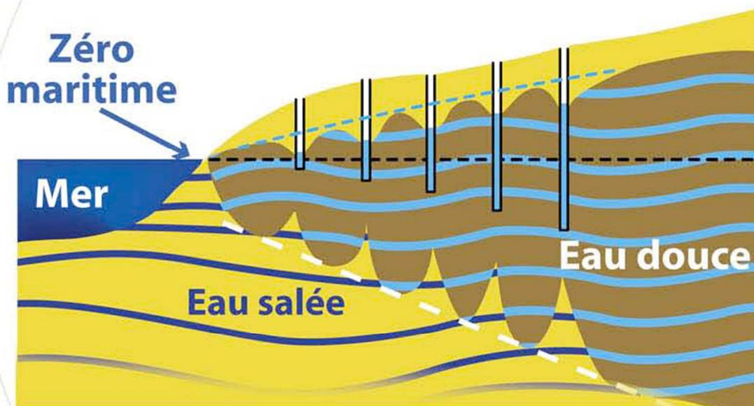
▲ Un faible rabattement contribue également à réduire les problèmes liés au fer : du fer dissous dans l'eau entraîne le colmatage de la crépine du forage et de la pompe.
