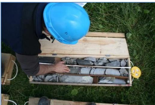
**Prélèvements géologiques: carottes du forage de 250 m de profondeur réalisé à St Brice.**
