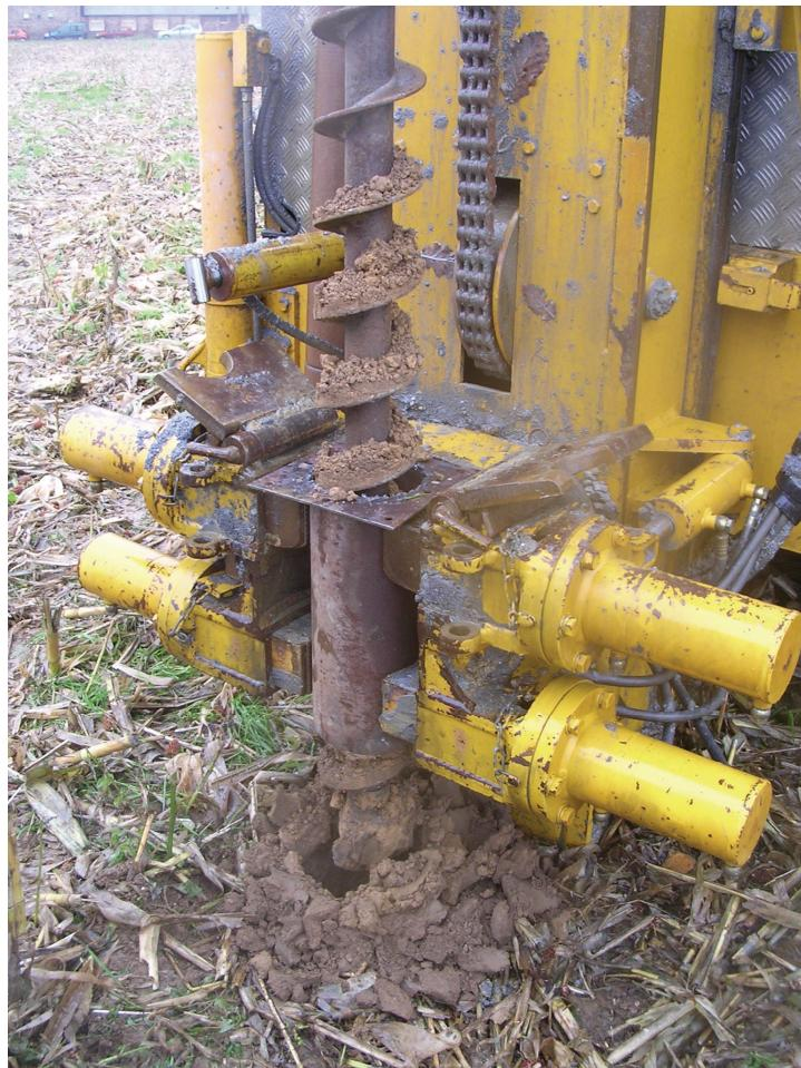
Figure 5 : Détail de la tarière hélicoïdale et remontée des déblais
