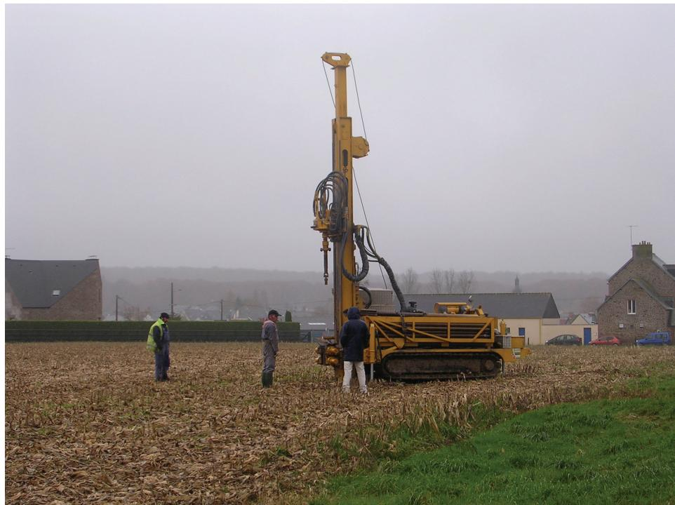
Figure 4 : Foreuse permettant de réaliser les sondages à la tarière
