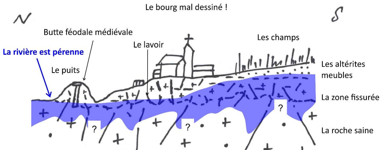
Figure 24 - Coupe géologique schématique interprétative Nord-Sud de la position de la nappe phréatique et du réservoir d'eau souterraine au niveau du village du Plessix-Balisson
